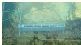
塩素が発生している状況
